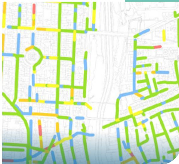
Todas estas inspecciones son incorporadas a una herramienta informática del Grupo Veolia, denominada **METRESA**, que nos **permite valorar de forma global el estado de la red de alcantarillado** de Elche y así poder priorizar, de forma objetiva, dónde realizar las inversiones de renovación y sustitución de las redes de alcantarillado que se encuentran en peor estado de conservación.
