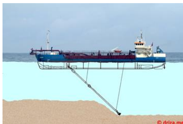
Figura 6.1. Buque especial draga para el acondicionamiento del fondo marino (Fuente: driza.me)
