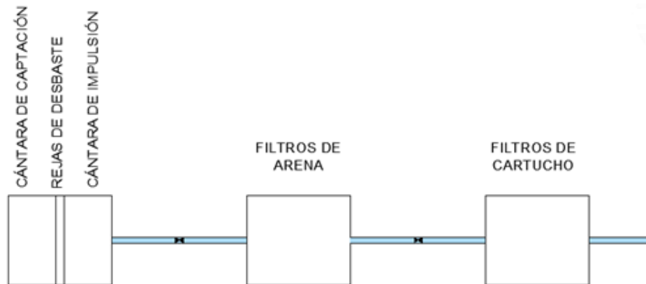
Figura 6.1. Esquema del bombeo de impulsión (Fuente: Elaboración propia).
